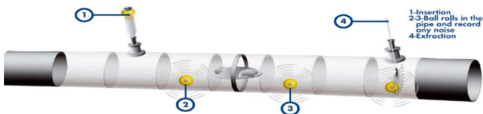
Bild 1. Principen för Smartball [24].
