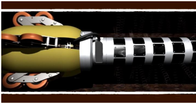
Bild 3. Pipescanner från Breivoll [25].
